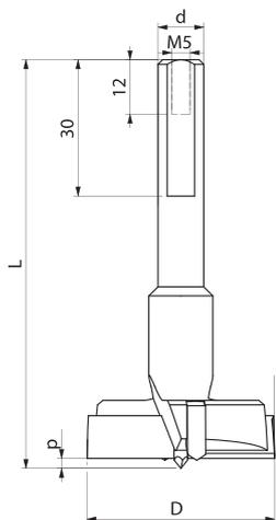
Сверло под петли с напайкой НМ, тип **TW-302** (левое), предназначено для высверливания отверстий под завесы в дереве, ДСП, MDF, ламинированных и других древесных плитах.
