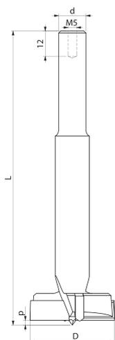
Сверло под петли с напайкой НМ, тип **TW-302** (левое), предназначено для высверливания отверстий под завесы в дереве, ДСП, MDF, ламинированных и других древесных плитах. Сверла с хвостовиком другим, чем  $d=10$  мм в стандарте выполняются без уплощения на хвостовике.
