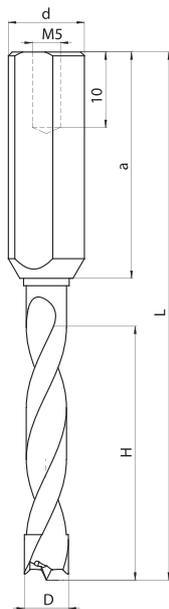
Глухие монолитные сверла с повышенной износостойкостью, тип **WN-31**, предназначены для профессиональной обработки дерева, ДСП, MDF, ламинированных и других древесных плит.
