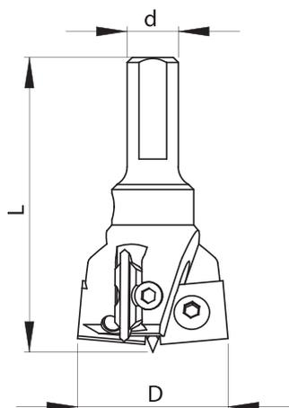
Концевая фрезерная головка под петли со сменными ножевыми пластинами, тип **FTS-30**, предназначена для высверливания отверстий под завесы в дереве, ДСП, MDF, ламинированных и других древесных плитах.
