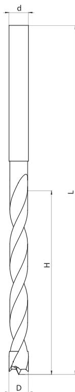
Глухие монолитные сверла с повышенной износостойкостью, тип **WN-46**, предназначены для профессиональной обработки дерева, ДСП, MDF, ламинированных и других древесных плит. Сверла характеризуются одинаковым диаметром рабочей части и хвостовика.
