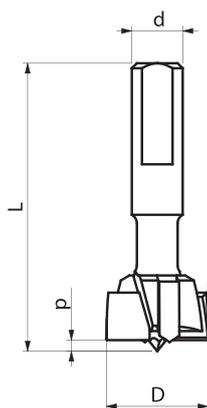
Сверло под петли с напайкой НМ, с уменьшенным направляющим острием, тип **TW-302A** (левое), предназначено для высверливания отверстий под завесы в дереве, ДСП, MDF, ламинированных и других древесных плитах. Специальная конструкция сверла – это укороченный направляющий остроконечник, который позволяет обрабатывать материал малой толщины без риска вырывания с другой стороны.
