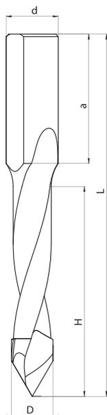
Сквозные сверла с напайкой НМ, тип **WP-01**, предназначены для профессиональной обработки дерева, ДСП, MDF, ламинированных и других древесных плит.
