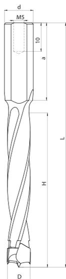
Сверла глухие с напайкой НМ, с двойной спиральной линией, тип **WN-07**, предназначены для профессиональной обработки дерева, ДСП, MDF, ламинированных и других древесных плит.
